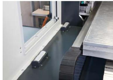
Durch ausgeklügelte Luft- und Kühlkanäle wird der gesamte Maschinenkörper und der Arbeitsraum auf konstante Temperatur gehalten. Nicht nur über den Tag wird somit ein Ansteigen der Temperatur eliminiert sondern auch über Nacht oder Wochenende bleibt die Maschine bei Absenken der Raumtemperatur auf konstanter Temperatur. Eine statische Verschiebung der Maschinengeometrie als meist große Unbekannte wird damit ausgeschlossen, zeitaufwändige Warmlaufphasen der Maschine entfallen.
